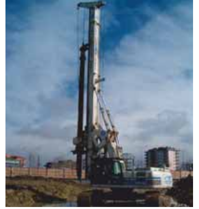
Soilmec Marka SR-60 2009 Model Fore Kazık Makinası MOTOR GÜCÜ: 261 Kw ÇALIŞMA AĞIRLIĞI: 63 TON MAKSİMUM ÇAPI: 1800 mm MAKSİMUM DERİNLİĞİ: 66 m MAKSİMUM TORK 201: kNm
